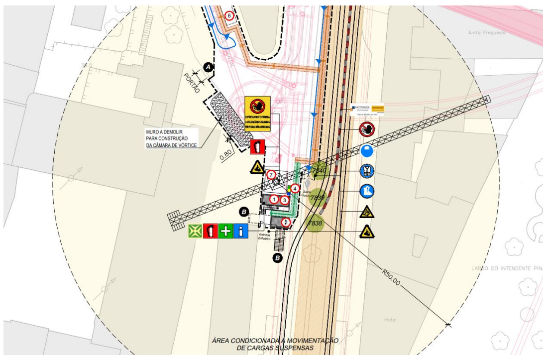
Imagem 1 – Novo desvio de tráfego enviado pela equipa PGDL
